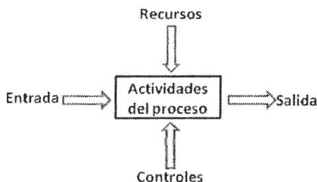
**Figura 1. Elementos básicos de un proceso.**
