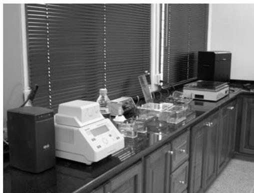
Figura 1. Termociclador, equipos de electroforesis horizontal y transiluminador de luz U.V.
